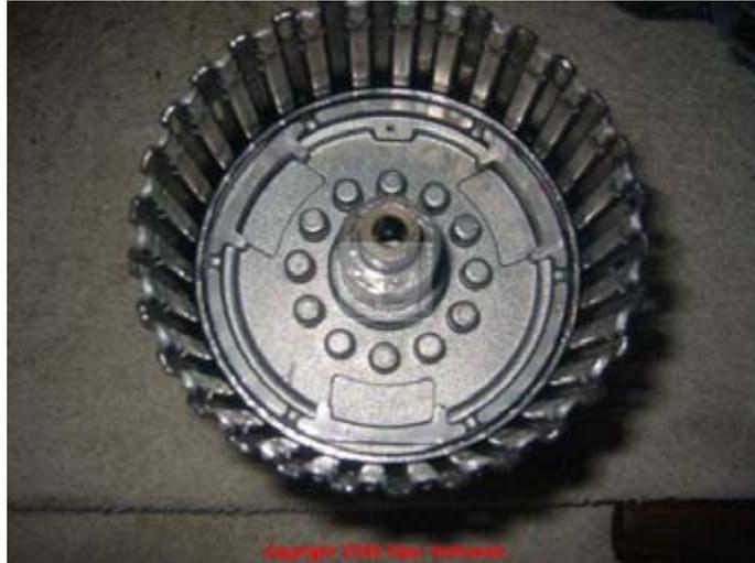
Place the 12 piston clutch springs 611 on 3<sup>rd</sup> clutch piston 638.
